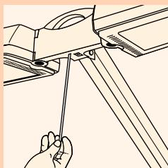
► Vous pouvez régler la hauteur nécessaire en utilisant le mètre à ruban de l'appareil.
