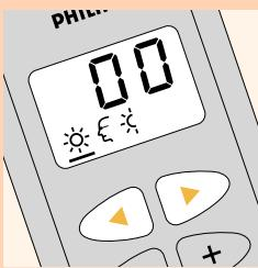
**1** Mit den Tasten **◀** und **▶** schalten Sie von Funktion zu Funktion. Das unterstrichene Symbol zeigt an, welche Funktion Sie gerade programmieren.
