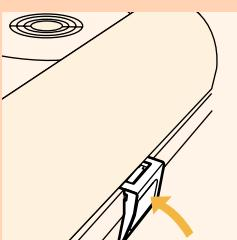
**10** Verrouillez les lampes sur la base avec les loquets en les poussant dans le sens de la flèche.
