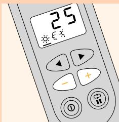
**1** Wenn Sie die Taste (+) drücken, wird die Dauer in aufsteigender Folge angezeigt; wenn Sie die Taste (-) drücken wird die Dauer in absteigender Folge angezeigt.
